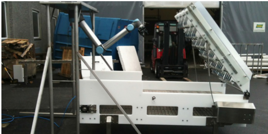
Figur 6.2. Prototype av robot som vasker fiskeprosesseringsmaskin.
