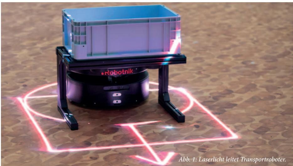
Abb. 1: Laserlicht leitet Transportroboter.
