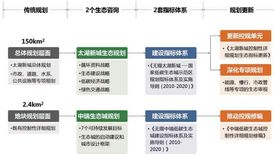
图 16 技术路线：传统规划—生态审视—指标体系—规划更新 来源：深圳市城市规划设计研究院有限公司
