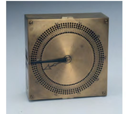
Mechanische Rechenmaschine, 1867 USA, Patentmodell aus Messing, ca. 5 x 13 x 13 cm, bestehend aus einem Addierwerk und einer drehbaren Multiplikationstabelle
