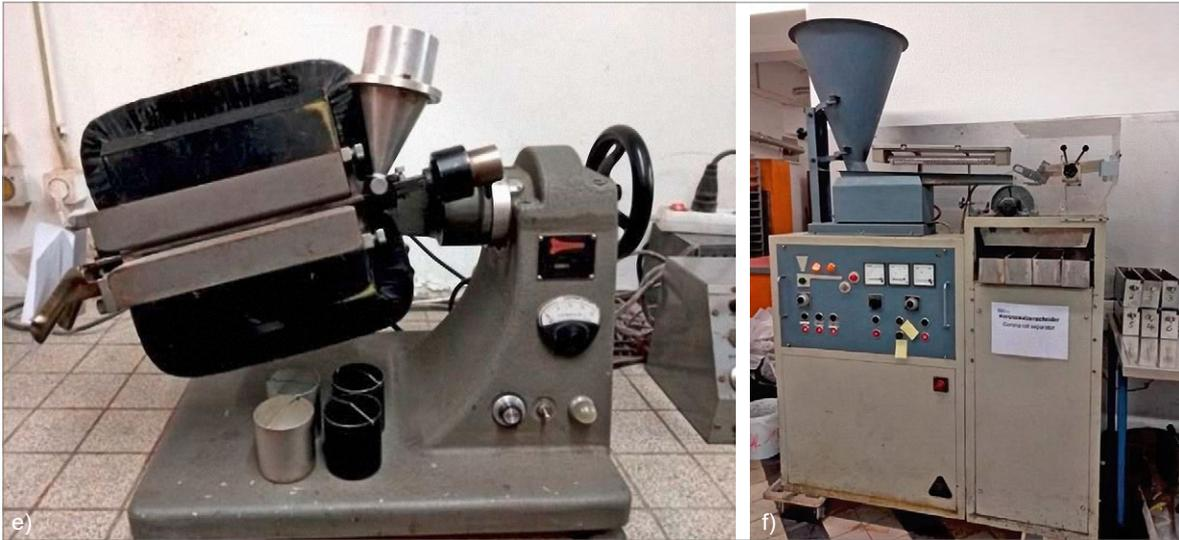
**Abb. 8: Probenaufbereitung mittels Frantz-Magnetabscheider (e) und Korona-Walzenseider (f) am Institut für Aufbereitung und Recycling der RWTH Aachen (IAR); (Fotos: PERSCHL 2018)**
