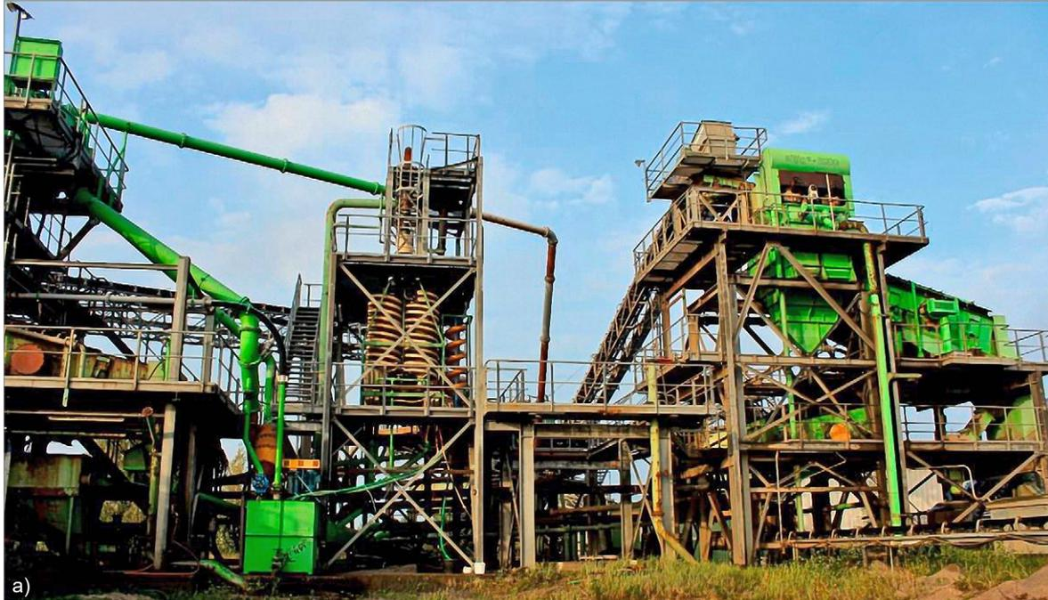
**Abb. 3: Aufbau der Probenahme mittels Sortierspirale im Kieswerk 23/24**
