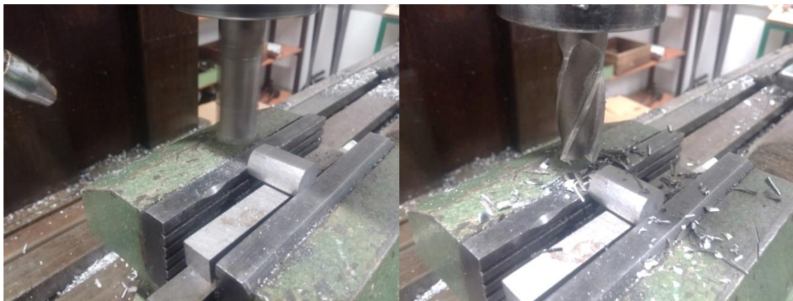
Slika 6 Priprema epruveta za mjerenje tvrdoće
