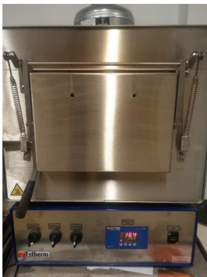
Slika 4 Progarnibilna laboratorijska peć DEMITERM EASY 9
