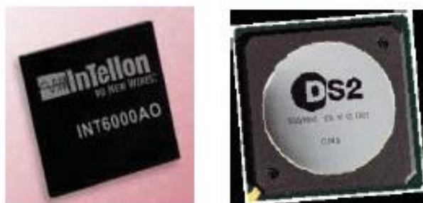
Slika 4.1.1 Prikaz integriranih širokopojasnih PLC modema [5]
