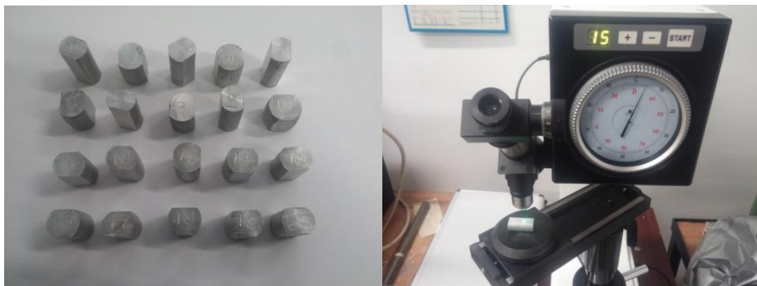
Slika 7 Epruvete pripremljene za mjerenje tvrdoće HB 2,5/62,5/15 (lijevo) i mjerenje tvrdoće epruveta pomoću univerzalnog tvrdomjera (desno)
