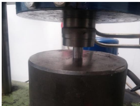
Slika 5 Plastična deformacija uzoraka između ploča hidraulične prese
