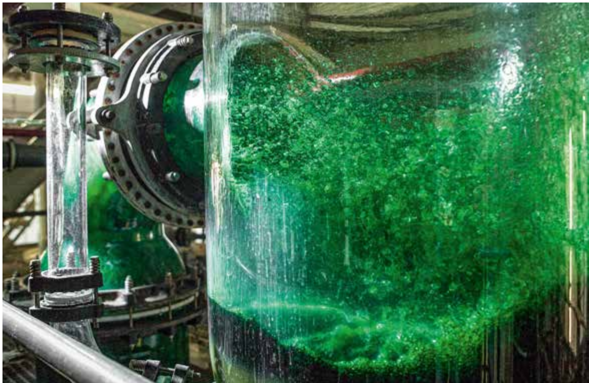
Abb. 25: Verdampfungs- und Kristallisationsprozess bei der Nickelsulfat-Produktion (Wiedergabe mit freundlicher Genehmigung der NICKELHÜTTE AUE GMBH).
