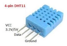
Figure 2 DHT11 sensor
